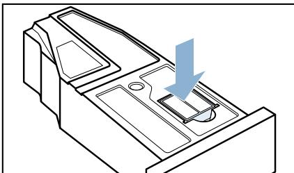
**12.** Inserire il contenitore dell'acqua di condensa fino all'arresto.
