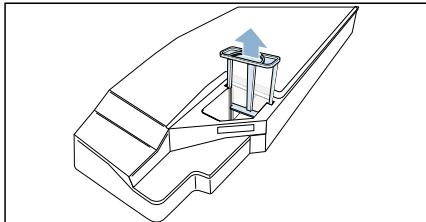
**11.** Inserire il filtro nell'incavo del contenitore dell'acqua di condensa.
