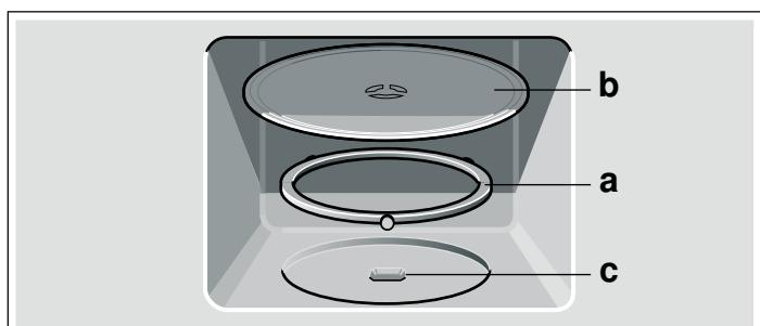
**Вказівка:** Використовуйте прилад лише із встановленою підставкою, що обертається. Проконтрольуйте, щоб вона була зафікована. Підставка може рухатися по колу ліворуч або праворуч.
