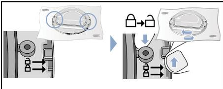
7. Heben Sie jetzt die Trocknertür vom Türriegel ab. Drehen Sie die Trocknertür und setzen diese wieder passend auf den Türriegel.
