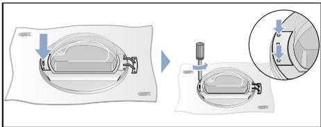
10. Entfernen Sie die Abdeckung vom Türschloss am Trockner und entnehmen diese.
