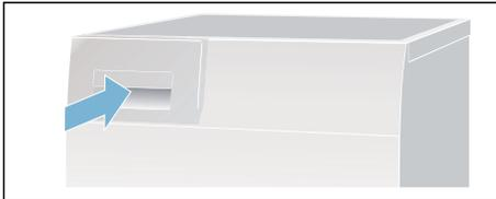
**Hinweis:** Das Sieb im Kondenswasser-Behälter filtert das Kondenswasser, das zur automatischen Reinigung Ihres Trockners verwendet wird. Das Sieb wird durch Entleeren des Kondenswassers gereinigt. Prüfen Sie das Sieb trotzdem regelmäßig auf verbliebene Ablagerungen und entfernen diese. Siehe → Seite 42.
