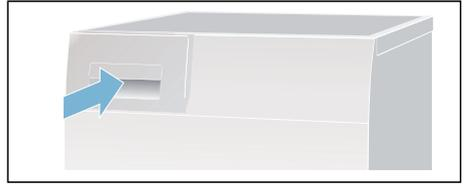
**Nota:** El filtro ubicado en el recipiente de agua de condensación filtra el agua de condensación que se utiliza para la limpieza automática de la secadora. El filtro se limpia al vaciar el agua de condensación. No obstante, es necesario comprobar periódicamente el filtro y eliminar los posibles residuos que se hayan podido acumular. Ver → *Página 48.*
