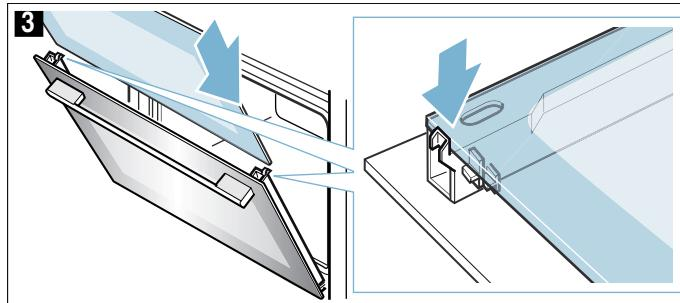
5. Poser le recouvrement et appuyer dessus jusqu'à ce qu'il s'encliquette de manière audible (fig. 4).
