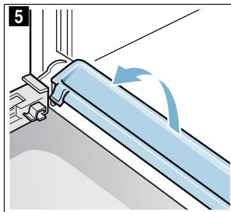
Nettoyez les vitres avec un nettoyant pour vitres et un chiffon doux. Essuyez la moulure pour eau de condensation avec un chiffon et du produit de nettoyage chaud.
