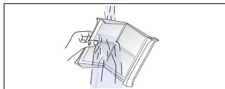
7. Asciugare i filtri per lanugine, chiuderli e reinserire il filtro per lanugine a due componenti.
