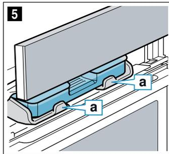
7. Blende langsam nach unten schieben, dann nach hinten drücken, bis sie vollständig geschlossen ist. Der Wassertank ist gefüllt. Sie können Betriebe mit Dampf starten.
