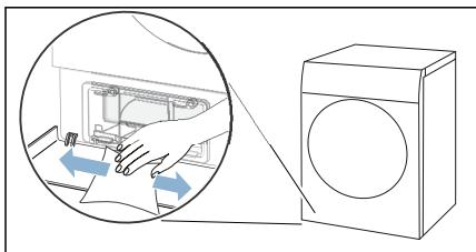
4. Odbravite ručice na poklopcu izmjenjivača temperature.
