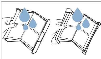
4. Razvucite dvodijelni filter za niti.
