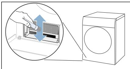
**Napomena:** Pazite da lamele izmjenjivača topline čistite odozgo prema dolje i da ih ne savijete ili oštetite.
