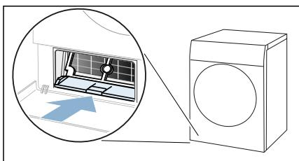
11. Klizno pomaknite poklopac izmjenjivača temperature prema unutra hvatajući ga za dršku.
