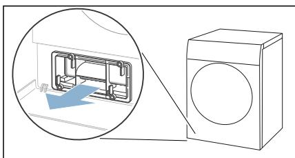
6. Oprezno skinite flis filtra s poklopca izmjenjivača topline.
