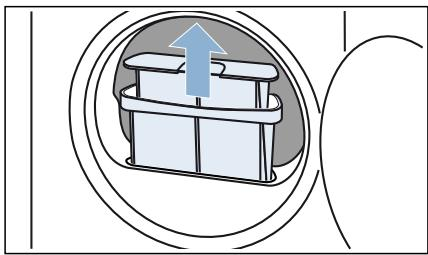
3. Uklonite niti iz filtera za niti. Pazite da niti ne dospiju u odvod.
