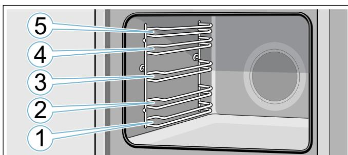
Das Zubehör immer zwischen die beiden Führungsstäbe einer Einschuhöhöhe schieben.
