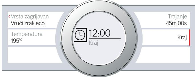
5. Pokrenite pritiskom na tipku start/stop . Na zaslonu se vidi vrijeme kada će uređaj početi s radom.
