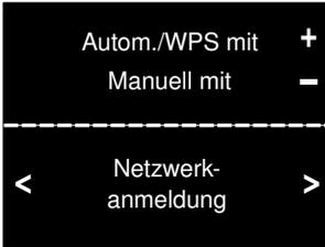
**Automatisch:** Die Verbindung mit dem Heimnetzwerk wird über die WPS-Funktion Ihres Routers hergestellt.
