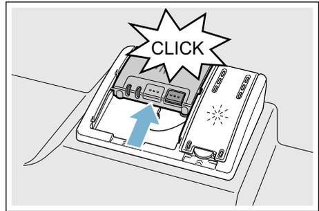
Il contenitore detersivo si apre automaticamente in funzione del programma, al momento opportuno. Il detersivo in polvere o liquido si distribuisce nell'apparecchio e si diluisce, la compressa cade nella vaschetta di raccolta compressa e qui si scioglie in modo dosato.
