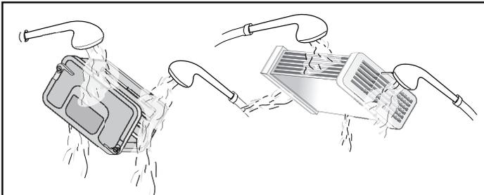
8. Enlevez les peluches et la charpie sur les joints de la sècheuse et de l'échangeur thermique.
