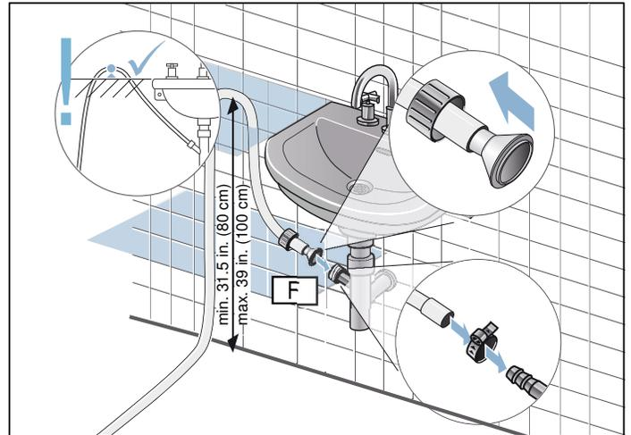
Pour l'installation, la hauteur minimale du drain montré ci-dessus est de 80 cm (31,5 po). La hauteur maximum du drain est de 100 cm (39 po).
