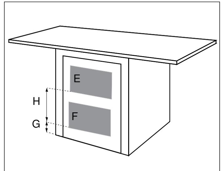
Si le devant de l'électroménager est couvert, prévoyez des ouvertures pour la ventilation.
