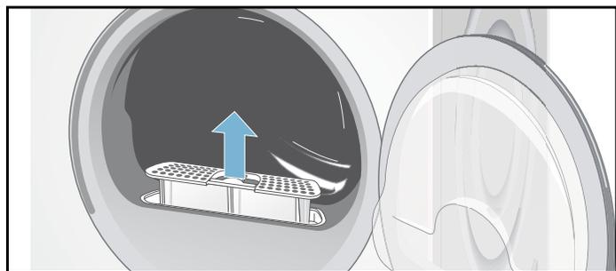
Retirez les peluches de la cavité du filtre à peluches. Assurez-vous qu'aucune peluche ne tombe dans le conduit ouvert.
