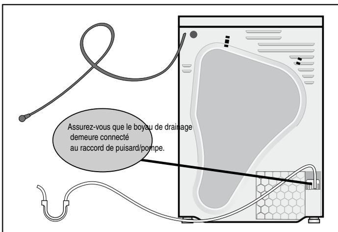
**AVIS :** Ne réutilisez pas un vieux tuyau de drainage ou un tuyau différent. Utilisez seulement le tuyau de drainage livré avec la sècheuse.
