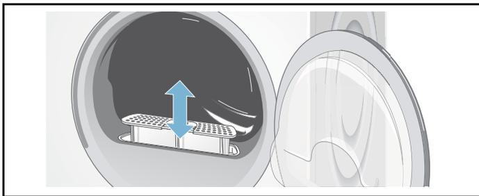
Le filtre doit être nettoyé après et avant chaque processus de séchage. Le nettoyage du filtre réduit le temps de séchage et économise l'énergie.
