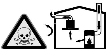
Grijala na plamen koja ovise o zraku iz prostorije (npr. plinska grijala, grijala na ulje i drva ili ugljen, protočni grijaci vode, uređaji za pripremu tople vode) troše zrak za sagorijevanje iz prostorije u kojoj je postavljen uređaj i odvode dimne plinove kroz dimovodne uređaje (npr. dimnjak) na otvoreno.
