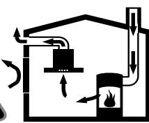
Grijala na plamen koja ovise o zraku iz prostorije (npr. plinska grijala, grijala na ulje i drva ili ugljen, protočni grijaci vode, uređaji za pripremu tople vode) troše zrak za sagorijevanje iz prostorije u kojoj je postavljen uređaj i odvode dimne plinove kroz dimovodne uređaje (npr. dimnjak) na otvoreno.
