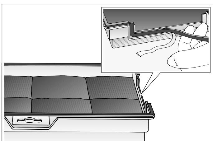
5. Filtar s aktivnim ugljenom umetnite sa stražnje strane, preklopite ga prema gore i u sredini pritegnite krilnom maticom. Ponovno ga umetnite kod uređaja s distantnom vodilicom.
