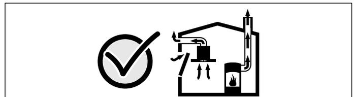
По вопросу оценки вентиляционной системы всего дома и разработке подходящих технических решений и по любому другому вопросу обращайтесь за консультацией в специальную инстанцию, отвечающую за эксплуатацию и чистку труб. Если вытяжка работает исключительно в режиме циркуляции воздуха, то эксплуатация возможна без ограничений.
