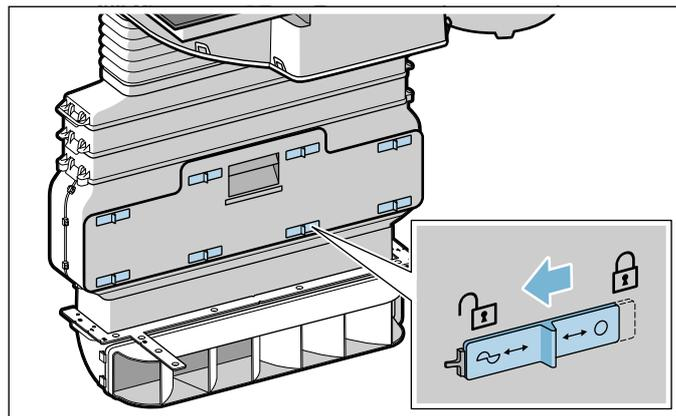
2. Откройте выдвижной ящик в плоском вытяжном канале и извлеките фильтр с активированным углём.
