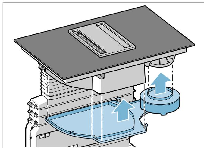
2. Опорожните и промойте ёмкость для слива лишней жидкости и, при необходимости, защитный корпус.
