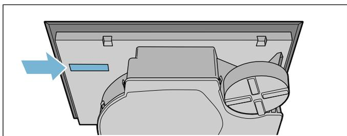
Номер E можно найти на стеклокерамической поверхности варочной панели. Вы можете проверить индекс сервисного центра (KI) и номер FD в меню базовых установок. См. главу → "Базовые установки".
