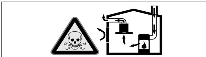
Приборы с открытым пламенем с подводом воздуха из помещения (например, работающие на газе, жидком топливе, дровах или угле нагреватели, проточные водонагреватели, бойлеры) получают воздух для сжигания топлива из помещения, где они установлены, а отработавшие газы отходят через вытяжную систему (например, вытяжную трубу) из помещения на улицу.
