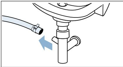
4. Ablaufschlauch und Siphon-Stutzen reinigen.
