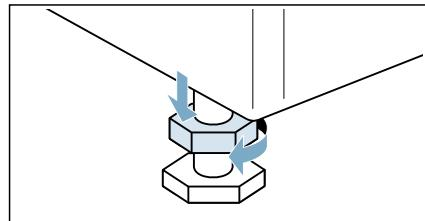
2. 請使用水平儀檢查電器的校準狀況，必要時予以調整。轉動本機的腳座可改變其高度。
