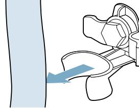
2. 擰鬆並拆下四個運輸鎖螺栓。
