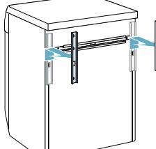
3. 擰鬆並拆下水平運輸支柱的螺絲。
