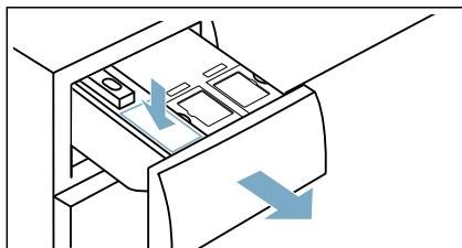
2. 根據以下情況將正確劑量的洗劑添加到左側洗劑添加槽：
