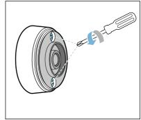
2. Aprire la copertura del sensore di temperatura. Estrarre la batteria dalla parte inferiore dell'alloggiamento e inserire una nuova batteria (prestare attenzione al corretto orientamento dei poli della batteria).
