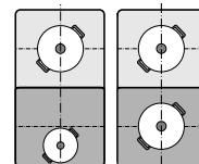
Las zonas delantera y trasera, con dos inductores cada una, pueden utilizarse de forma independiente, ajustando la potencia necesaria en cada una de ellas. En este caso se recomienda utilizar sólo un recipiente en cada zona.
