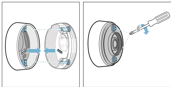
4. Colocar de nuevo el protector de silicona en la base del Sensor de cocción.
