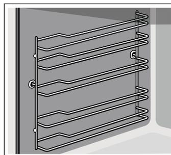
1. Levante um pouco **a** a parte da frente da estrutura de suporte e desencaixe-a **b** (figura **1**).
