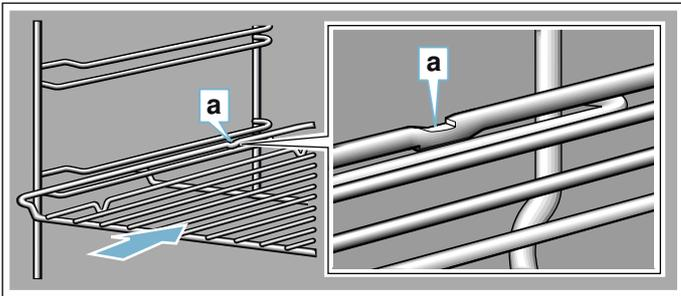
Ao inserir a grelha, certifique-se de que a saliência de encaixe **a** se encontra atrás e de que está virada para baixo. A frente da chanfradura do acessório **b** deve estar virada para a porta do aparelho.
