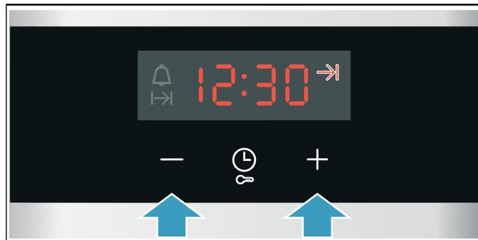
Через кілька секунд прилад приймає налаштування. На дисплеї з'являється час завершення. Як тільки відбувається запуск приладу, відображається відлік тривалості.
