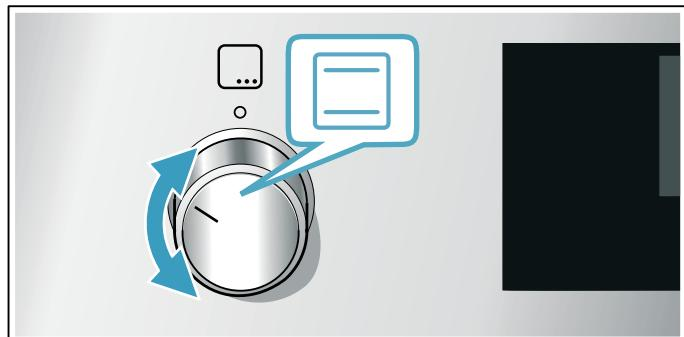
2. За допомогою регулятора температури встановіть температуру або режим гриля.
