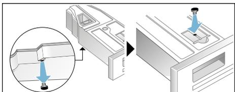
8. Estrarre il filtro dallo scomparto e inserirlo nell'incavo del contenitore dell'acqua di condensa.
