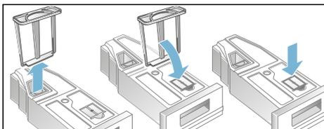
9. Inserire il contenitore dell'acqua di condensa fino all'arresto.
