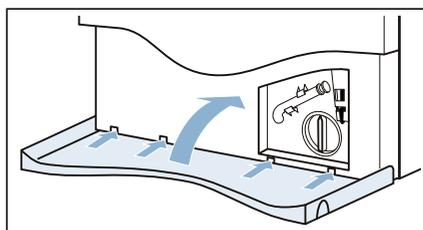
**Remarque :** Pour éviter que le détergent non utilisé ne s'écoule dans le boyau de vidange lors du prochain lavage : versez environ 1 litre d'eau dans le compartiment II et démarrez le programme **Rinçage/Essorage/Vidange**.
