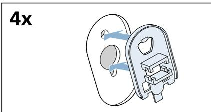
4. Verrouillez les couvercles en place en appliquant une pression sur les crochets d'encliquetage.
