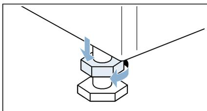
2. Vérifiez l'alignement de l'appareil avec un niveau à bulle et modifiez-le si nécessaire. Modifiez la hauteur en tournant les pieds de l'appareil. Les quatre pieds de l'appareil doivent reposer fermement sur le sol.
