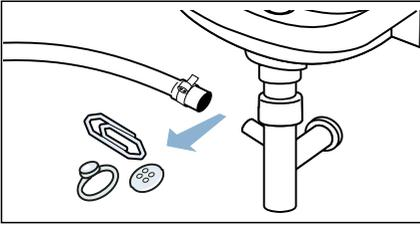
4. Rattachez le tuyau de vidange et sécurisez le point de raccordement à l'aide du collier de serrage.
