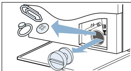
5. Remplacez et vissez le couvercle de la pompe. La poignée doit se trouver en position verticale.
