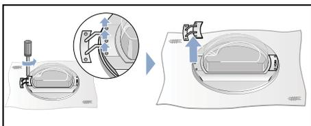
5. Desatornillar los tornillos del tirador de la puerta y retirar el tirador.
