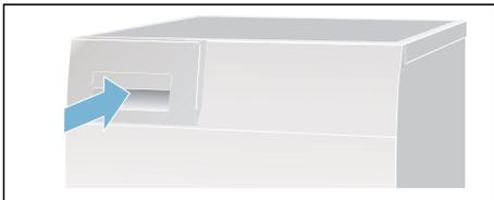
**Nota:** El filtro ubicado en el recipiente de agua de condensación filtra el agua de condensación que se utiliza para la limpieza automática de la secadora. El filtro se limpia al vaciar el agua de condensación. No obstante, es necesario comprobar periódicamente el filtro y eliminar los posibles residuos que se hayan podido acumular. Ver → *Página 47.*
