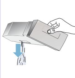
Vaciar el recipiente para agua condensada.
