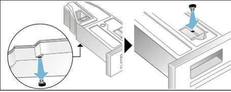
8. Soltar el filtro del enganche y colocarlo en la ranura del recipiente para agua condensada.
