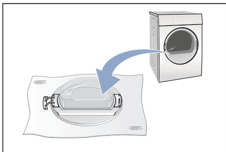
4. Ahora, desatornillar los tornillos de la bisagra de la puerta y retirar la bisagra.
