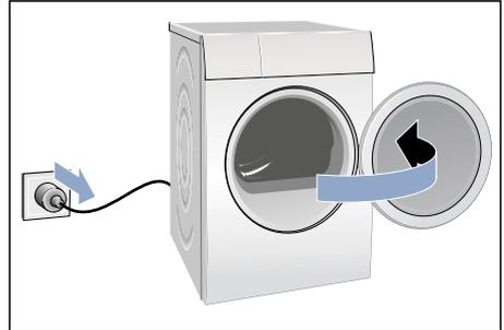
2. Sacar los tornillos de la secadora y, a continuación, retirar la puerta de la misma.
