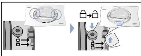
7. Ahora, levantar la puerta de la secadora separándola del aro. Girar la puerta de la secadora y volver a colocarla en el aro de manera que encaje.
