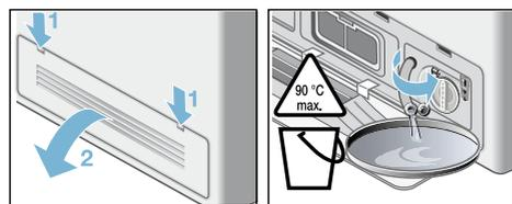
5. Retirez le volet obturateur, laissez le bain lessiviel s'écouler dans un récipient adéquat. Enfoncez le volet obturateur et mettez le flexible de vidange en place dans la fixation.
