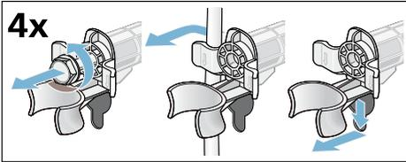
5. Insérez les couvercles. Verrouillez en appuyant sur le crochet de verrouillage. Insérez le support du flexible.
