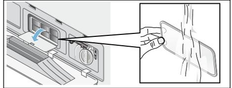
4. Retirez les peluches du filtre à air à l'aide d'une brosse sous de l'eau courante.
