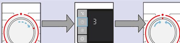
Tourner de 1 cran dans le sens des aiguilles d'une montre.
