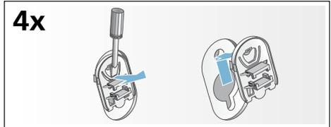
2. Mettez les 4 douilles en place. Bridez fermement le cordon d'alimentation électrique contre les fixations. Mettez les vis en place et serrez-les à fond.
