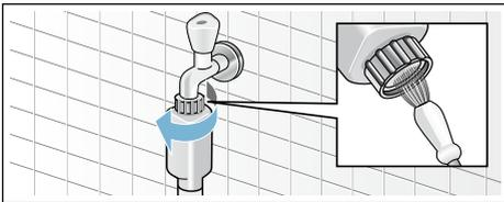
6. Nettoyage du filtre à l'arrière de l'appareil : Retirez le flexible au dos de l'appareil. Extrayez le filtre avec une pince et nettoyez-le.
