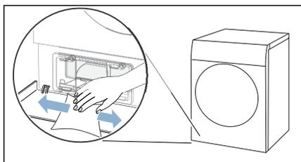
3. Desbloqueie a alavanca da cobertura do permutador térmico.
