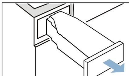
8. Rode o recipiente de água de condensação 180° na parte inferior e remova o tampão colocado.
