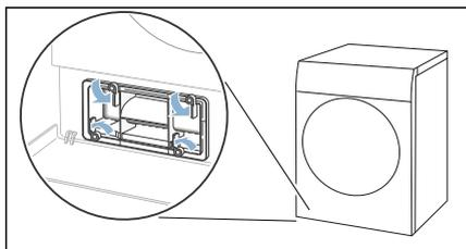
4. Remova a cobertura do permutador térmico no puxador.
