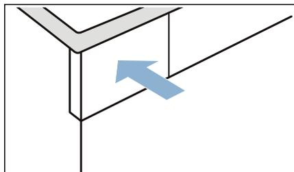
**Conselho:** O filtro presente no recipiente de água de condensação filtra a água de condensação, que é usada para a limpeza automática do seu aparelho. O filtro é limpo através do esvaziamento da água de condensação. Apesar disso, verifique o filtro regularmente quanto à presença de depósitos e remova-os, se necessário.
