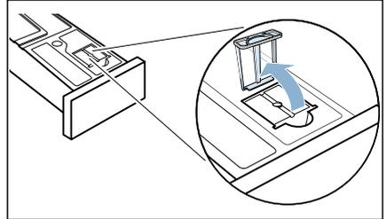
2. Remova o tampão colocado no rebaixo do recipiente de água de condensação.
