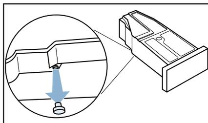
9. Volte a rodar o recipiente de água de condensação 180° e insira o tampão no rebaixo, na parte superior do recipiente de água de condensação.
