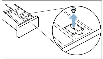
3. Rode a parte inferior do reservatório da água de condensação 180° e coloque o tampão.
