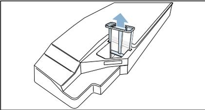
11. Coloque o filtro no rebaixo do recipiente de água de condensação.
