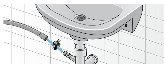
使用 Ø 0.9 - 1.6 吋（20-44 公釐）水管夾（可至材料行購買），將排水管固定至虹吸管上。
