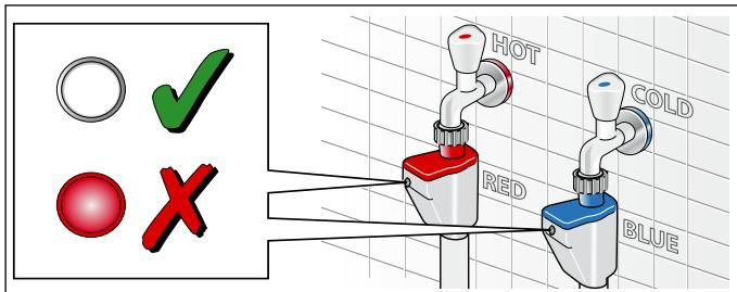
Aqua-Secure 軟管可在軟管出現內部裂隙時，防止漏水情形發生。如果出現漏水情形，軟管上的指示燈會變成紅燈，並封鎖給水。當軟管的內部閥門啟動後（指示燈變紅）即需更換。請聯絡客戶服務中心購買備品。
