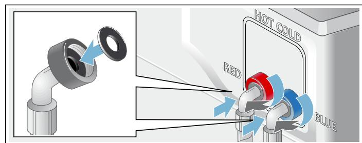
將此軟管末端連接到洗衣機背面，如下圖所示。務必依指示使用固定夾以及配置軟管。只能用手鎖緊。
