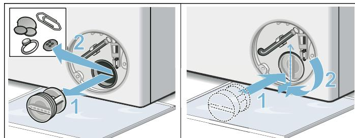
6. 以逆時針方向旋開泵浦蓋，並將泵浦蓋取下。此時可能會有少量殘留水流出。
