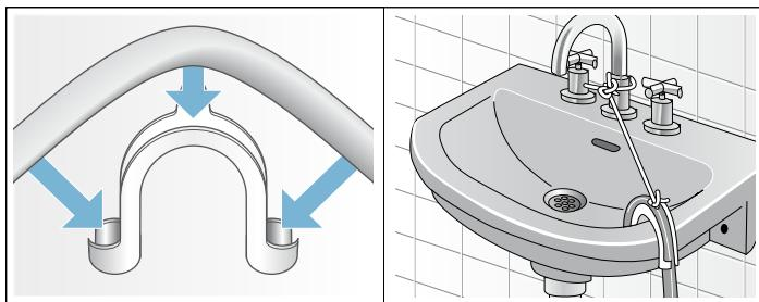
排水管牢固地連接至洗滌槽。
