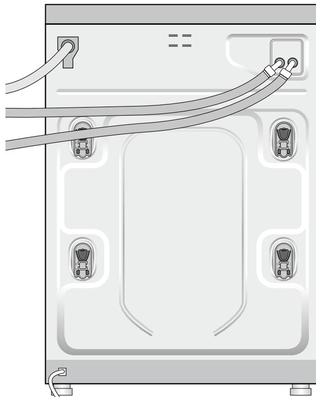
往洗衣機左側（面對前方）配置軟管時，請依圖示固定軟管。
