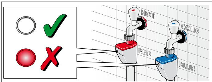
Aqua-Secure 軟管可在軟管出現內部裂隙時，防止漏水情形發生。如果出現漏水情形，軟管上的指示燈會變成紅燈，並封鎖給水。當軟管的內部閥門啟動後（指示燈變紅）即需要更換。請聯絡客戶服務中心購買備品。
