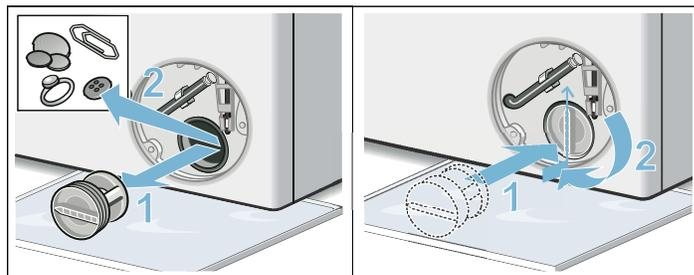
6. 以逆時針方向旋開泵浦蓋，並將泵浦蓋取下。此時可能有少量殘留水流出。清理泵浦內部，將所有線屑與異物清除。確認泵浦外殼後方葉輪已能順利轉動。清除所有在泵浦蓋螺紋與外殼上的線頭、線屑或洗劑殘留物。將泵浦蓋裝回並將螺絲鎖緊。泵浦蓋上的轉柄必須保持垂直。
