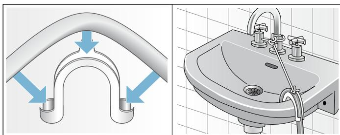
排水管牢固地連接至洗滌槽。
