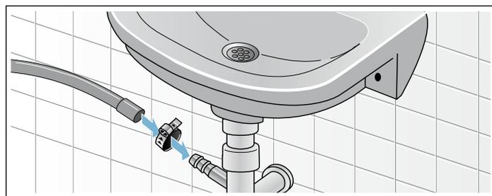
使用  $\varnothing 0.9 - 1.6$  吋 (20-44 公釐) 水管夾 (可至材料行購買)，將排水管固定至虹吸管上。
