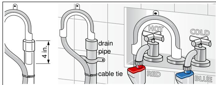
使用洗衣機隨附的彎頭連接排水軟管。將彎頭放置在軟管尾端 4 吋的位置，如圖所示。將此突出部分插入排水管的排水軟管。用尼龍束帶或類似物品固定彎頭，以確保在使用過程中軟管不會與水管脫離。
