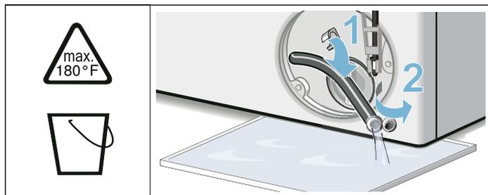
5. 利用泵浦開口中的可外拉排水軟管，將剩餘的水排到適當的容器中（最高排水量為 5.3 美制加侖 / 20 公升）。取下軟管封蓋，將軟管放入容器中，排乾滾筒中的水。將滾筒中的水排乾後，裝回軟管封蓋，並將軟管放回原來位置。
