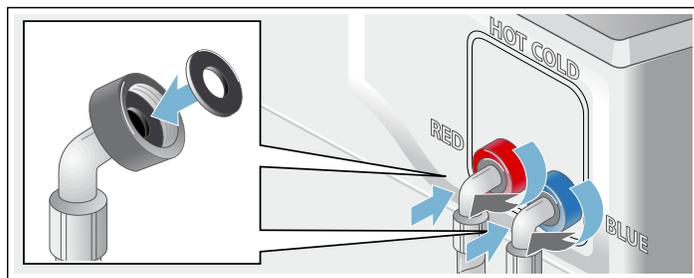
將此軟管末端連接到洗衣機背面，如下圖所示。務必依指示使用固定夾以及配置軟管。只能用手鎖緊。
