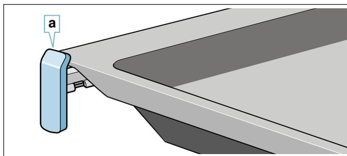
Les rails télescopiques s'encliquettent lorsqu'ils sont entièrement retirés. Il est ainsi facile de poser l'accessoire dessus. Pour le déverrouillage, repoussez les rails télescopiques dans le compartiment de cuisson avec une légère pression.
