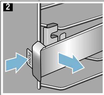
3. Tirez le rail vers l'avant jusqu'à ce que la fixation de derrière soit décrochée (fig. 3).
