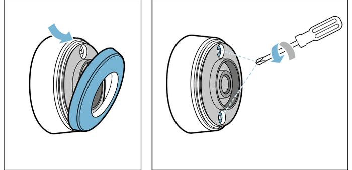
2. Åpne dekselet til temperatursensoren. Ta batteriet ut av underdelen av huset, og sett inn et nytt batteri (pass på at pluss- og minuspolen vender riktig vei).
