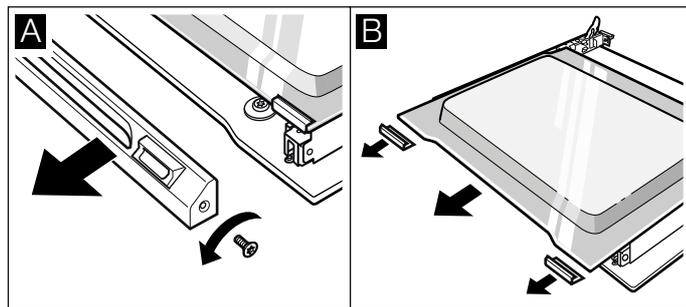
4. Dévisser les crochets à droite et à gauche. Lever la vitre et enlever les crochets de la vitre (fig. C).
