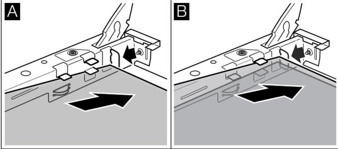
3. Fixer les crochets sur la vitre à droite et à gauche, aligner de sorte que les ressorts se trouvent au-dessus du trou de vissage et visser (fig. C).
