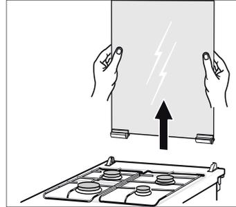
Si les charnières du couvercle se détachent, repérez les lettres qui se trouvent dessus. La charnière marquée de la lettre R doit être montée à droite, la charnière avec la lettre L à gauche.
