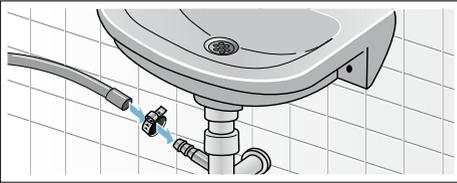
■ **Raccordo di scarico a muro con manicotto in gomma oppure libero scarico nel pozzetto**
