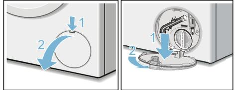
4. Staccare il tubo flessibile di svuotamento dal suo alloggiamento. Estrarre il tappo di chiusura. Fare scorrere l'acqua in un idoneo contenitore. Applicare il tappo di chiusura e ricollocare il tubo flessibile di svuotamento nel suo alloggiamento.
