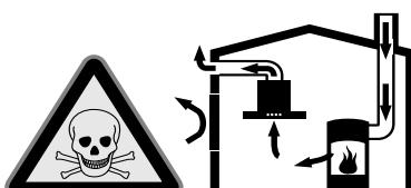
Grijala na plamen koja ovise o zraku iz prostorije (npr. plinska grijala, grijala na ulje i drva ili ugljen, protočni grijaci vode, uređaji za pripremu tople vode) troše zrak za sagorijevanje iz prostorije u kojoj je postavljen uređaj i odvode dimne plinove kroz dimovodne uređaje (npr. dimnjak) na otvoreno.
