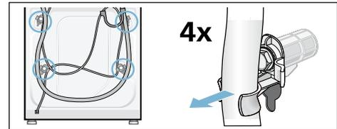
2. Alle 4 Transportsicherungsschrauben lösen und entfernen. Hülsen entfernen. Dabei Netzleitung aus den Halterungen nehmen.
