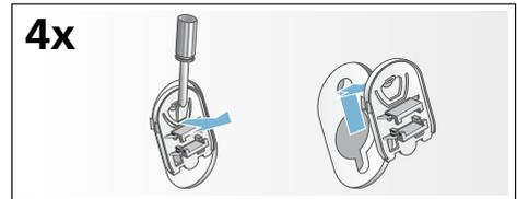
2. Alle 4 Hülsen einsetzen. Netzleitung an den Halterungen festklemmen. Schrauben einsetzen und festziehen.
