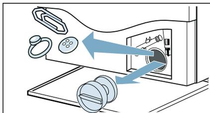
5. Reinstale e aparafuse a cobertura da bomba. A pega tem de estar numa posição vertical.
