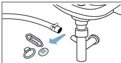
4. Volte a conectar a mangueira de escoamento e fixe o ponto de ligação usando a braçadeira da mangueira.
