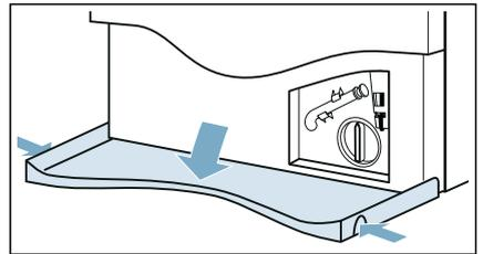
3. Retire a mangueira de escoamento do retentor. Remova a tampa de vedação e verta a água para um recipiente adequado. Substitua a tampa de vedação e recoloque a mangueira de escoamento no retentor.
