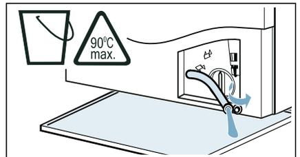
4. Desaparafuse cuidadosamente a cobertura da bomba; poderá sair água residual. Limpe o interior, a rosca da cobertura da bomba e o respetivo alojamento. O impulsor na bomba de escoamento tem de ser capaz de girar.
