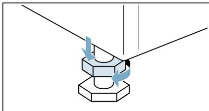
2. Verifique o alinhamento do aparelho com um nível de bolha e ajuste, se necessário. Altere a altura, rodando os pés do aparelho. Todos os quatro pés do aparelho têm de estar firmemente assentes no chão.
