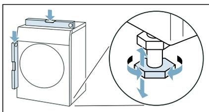
3. Aperte a porca de bloqueio contra a caixa. Ao fazê-lo, mantenha o pé firme e não ajuste a sua altura. As porcas de bloqueio nos quatro pés do aparelho têm de ser bem aparafusadas à caixa.
