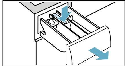
2. Desloque o auxiliar de medição para a frente, dobre-o e encaixe-o no lugar.
