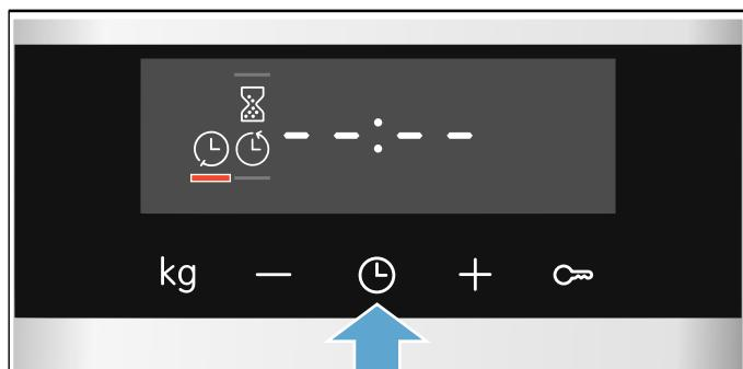
4. Измените время окончания на более позднее с помощью кнопок или .
