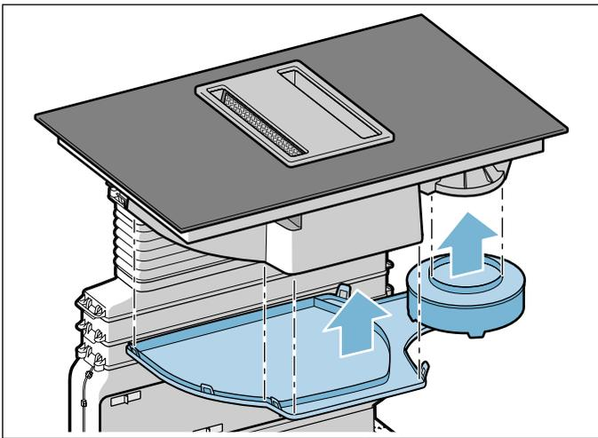
2. Videz le réservoir de trop-plein et le cas échéant, le capot de l'appareil, et nettoyez-les.
