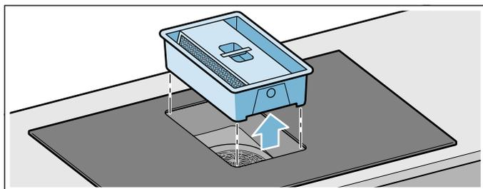
3. Appuyez sur les deux éléments de fermeture sur les côtés du réservoir pour séparer le filtre à graisse métallique du réservoir.
