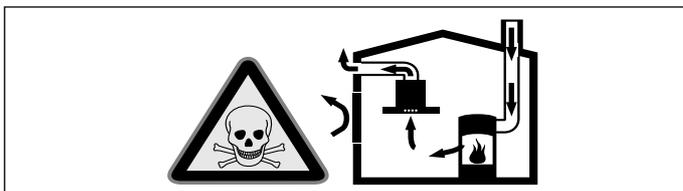
Les foyers à air ambiant (par exemple les chauffages à gaz, à bois, à fioul ou à charbon, les chauffe-eau instantanés, les ballons d'eau chaude) prélèvent l'air de combustion dans la pièce où ils sont installés et rejettent les gaz de fumée à l'air libre par un système spécifique (par exemple cheminée).
