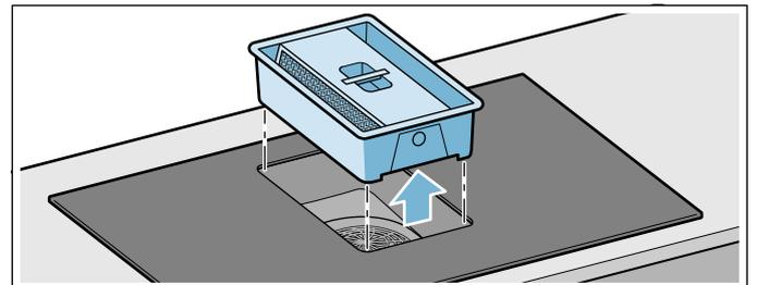
**Remarque :** la graisse peut s'accumuler dans le bas du réservoir. Pour éviter tout égouttement de graisse, n'inclinez pas le filtre à graisse métallique.
