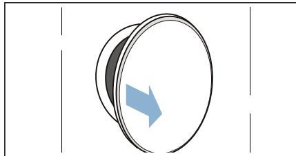
2. Feuchtigkeitssensor mit angerauhtem Schwamm reinigen.
