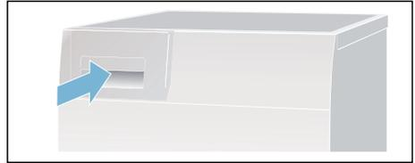
**Hinweis:** Das Sieb im Kondenswasser-Behälter filtert das Kondenswasser, das zur automatischen Reinigung Ihres Trockners verwendet wird. Das Sieb wird durch Entleeren des Kondenswassers gereinigt. Prüfen Sie das Sieb trotzdem regelmäßig auf verbliebene Ablagerungen und entfernen diese. Siehe → Seite 44.
