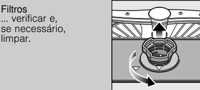
Rodar o filtro cilíndrico e retirar o sistema de filtros ...
