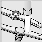
промойте отверстия в проточной воде (при необходимости воспользуйтесь зубочисткой) ...
