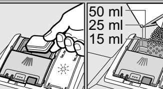
Моющее средство следует загружать лишь в сухую предназначенную для него ячейку.
