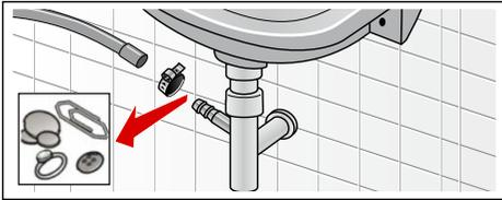
4. Rattachez le tuyau de vidange et sécurisez le point de raccordement avec le collier de serrage.
