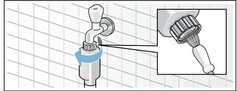
6. Nettoyage du filtre à l'arrière de l'appareil : Retirez le flexible au dos de l'appareil. Extrayez le filtre avec une pince et nettoyez-le.
