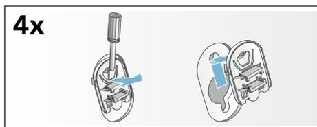
2. Mettez les 4 douilles en place. Bridez fermement le cordon d'alimentation électrique contre les fixations. Mettez les vis en place et serrez-les à fond.
