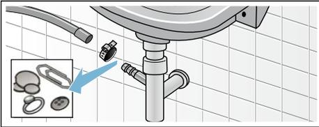
4. Ricollegare il tubo flessibile di scarico e assicurare il punto di connessione con la fascetta stringitubo.
