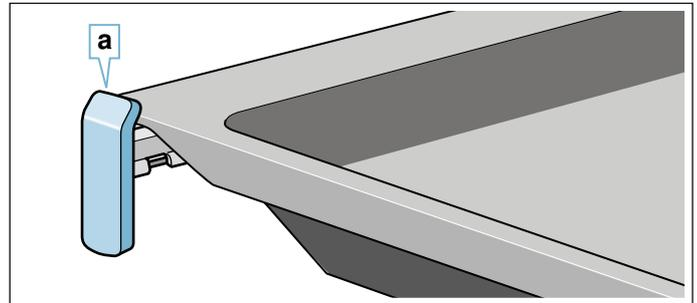
As calhas extensíveis encaixam quando estiverem totalmente extraídas. Desta forma, coloca-se facilmente o acessório. Para desencaixar as calhas extensíveis, empurre-as para o interior do aparelho exercendo alguma pressão.
