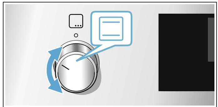
2. Regule a temperatura ou a potência do grelhador com o seletor de temperatura.
