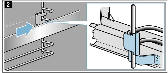
3. Pressione "PUSH" e vire a calha para dentro, de modo a que o suporte se encontre entre as duas barras (figura 3).
