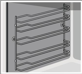
1. Levante um pouco **a** a parte da frente da estrutura de suporte e desengate-a **b** (figura **1**).
