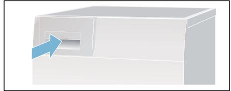
**Hinweis:** Das Sieb im Kondenswasser-Behälter filtert das Kondenswasser, das zur automatischen Reinigung Ihres Trockners verwendet wird. Das Sieb wird durch Entleeren des Kondenswassers gereinigt. Prüfen Sie das Sieb trotzdem regelmäßig auf verbliebene Ablagerungen und entfernen diese. Siehe → Seite 34.
