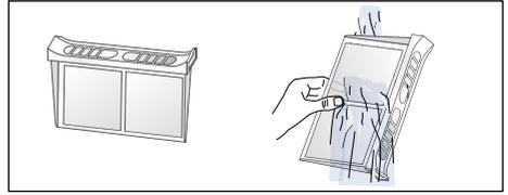
6. Séchez le filtre à peluches, fermez-le et réinsérez-le.
