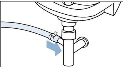
■ **Ablauf in ein Kunststoffrohr mit Gummimuffe oder einen Gully**
