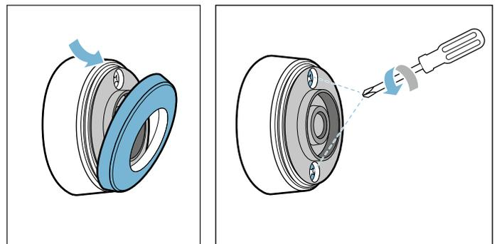
2. Den Verschluss des Temperatursensors öffnen. Die Batterie aus dem Gehäuseunterteil herausnehmen und eine neue Batterie einsetzen (dabei auf die richtige Ausrichtung der Batteriepole achten).
